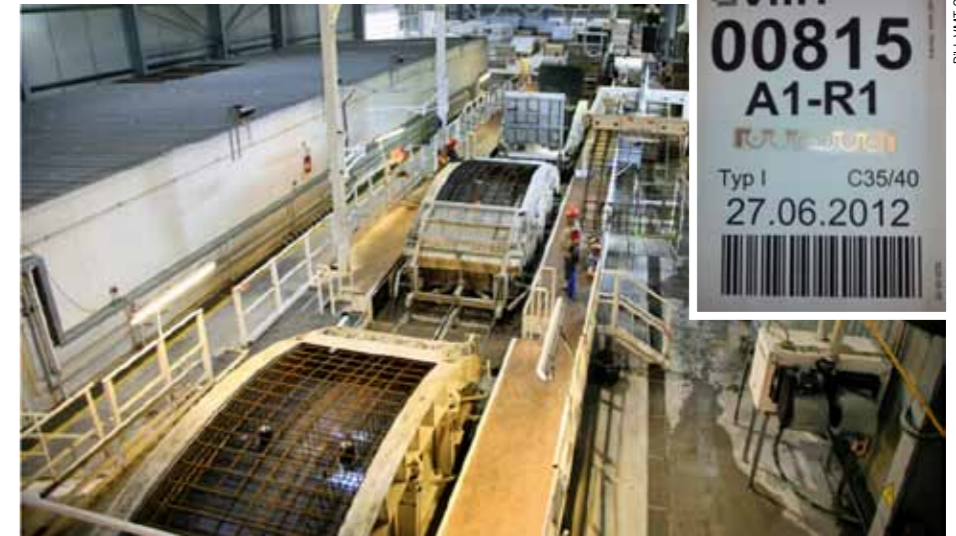
Herstellung von Tübbingen mit dem Herrenknecht SDS-System: Jedes Element wird mit Tags eindeutig identifiziert (kleines Bild).
