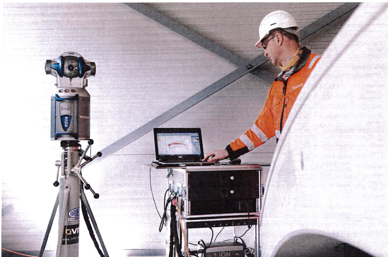
Kontrollvermessung mit 3D-Laser-Tracker Control measurement with 3D laser tracker
