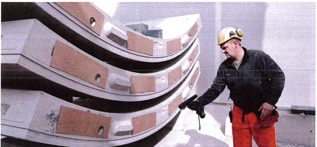
Scan eines Tübbingstapels für die Einlagerung Scanning a stack of segments for storage
